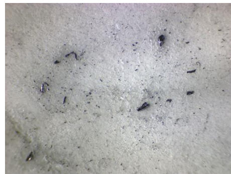
Residui di particelle dopo una sola incisione della treccia di schermatura; Trefolo schermatura in acciaio; \varnothing 0,3 mm; lunghezza massima delle particelle ca.. 0,7 mm
