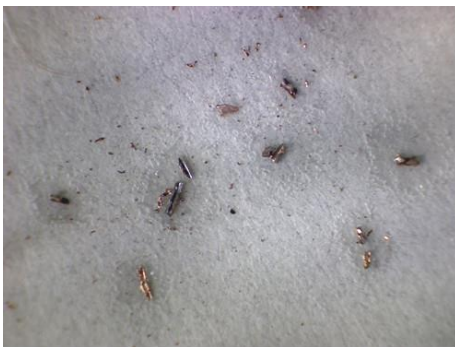
Residui di particelle dopo una sola incisione della treccia di schermatura; Trefolo schermatura in rame; inscatolato; \varnothing 0,15 mm; lunghezza massima delle particelle ca.. 0,9 mm
