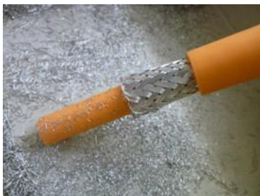
Magliatura di un cavo HV con particelle di trefolo
