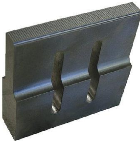
Retângulo - Níveis - Sonotrodo para soldadura de tecidos; 35 kHz; 2 ranhuras; serrilhado
