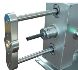
Dettaglio area lavoro e tubo di taglio
