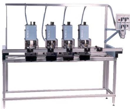
Urządzenie obsługujące kilka głowic z mocowaniem dla falcowania i druku tekstu
